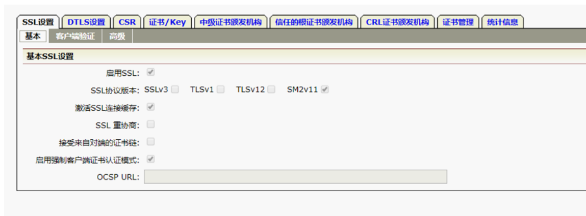
图 C.2- 18 SSL VPN 网关 SSL 协议配置界面
