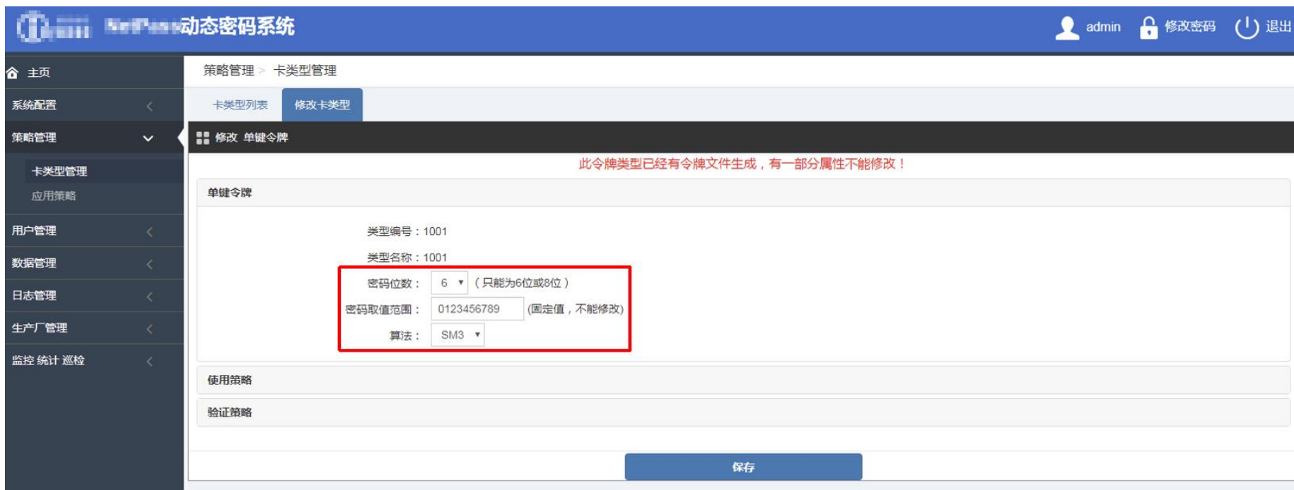
图 C.3- 6 动态口令认证系统上动态口令生成算法、动态口令长度和取值范围等配置信息（基于 SM3 算法生成动态口令）
