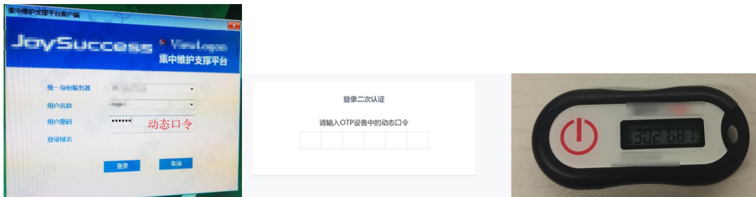
图 C.3- 3 堡垒机用户登录时输入动态令牌产生的动态口令（长度为 6 位）
