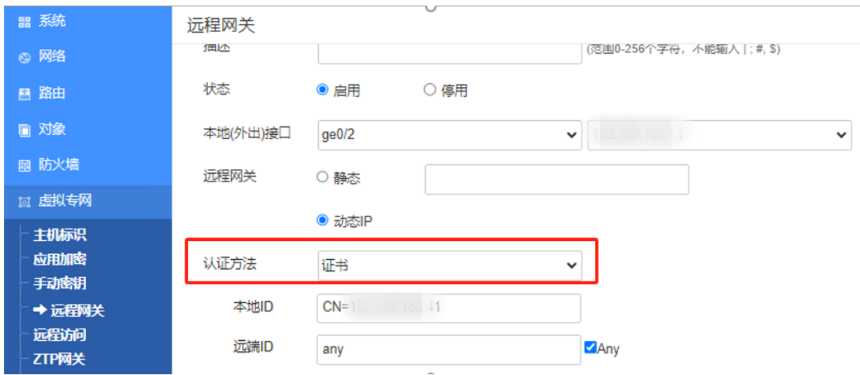
图 C.2- 7 IPsec VPN 网关的实体鉴别方式配置界面（采用数字证书鉴别方式）
