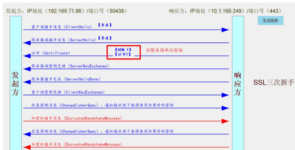
图 C.3- 8 通过 TLSv1.2 协议对堡垒机进行远程管理时的通信双方 IP 地址（10.XX.XX.249、192.XX.XX.86）、端口服务开启情况（目的端 TCP 443）和实体鉴别应用机制（单向鉴别）
