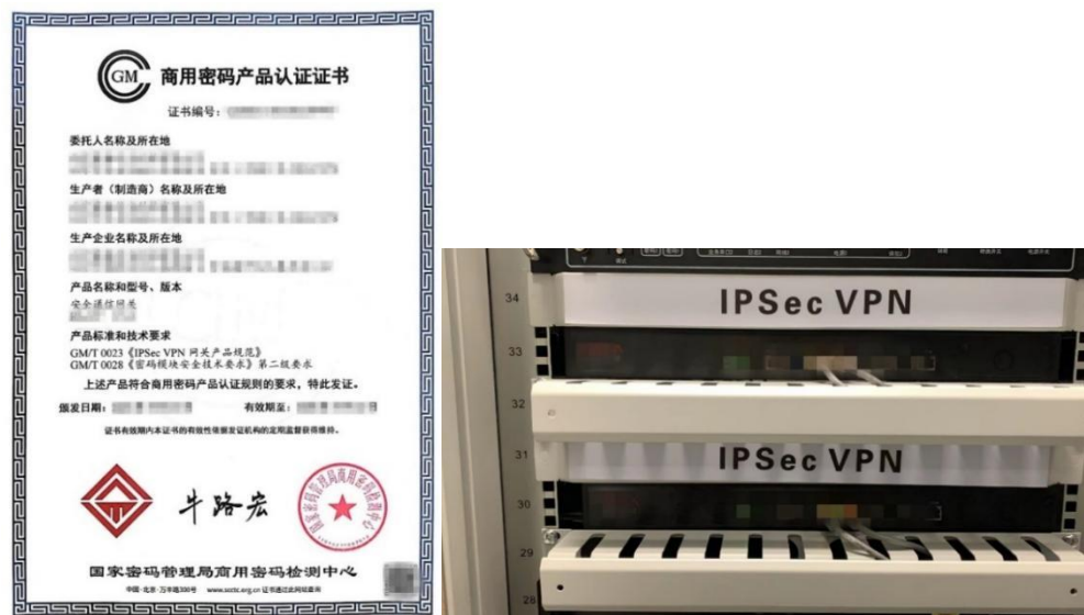
图 C.2- 1 IPsec VPN 网关商用密码产品认证证书及实物图
