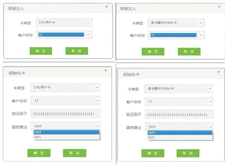
图 C.1- 4 安全门禁系统后台管理系统发卡子系统的发卡过程及密码算法相关配置（使用 SM4 算法）
