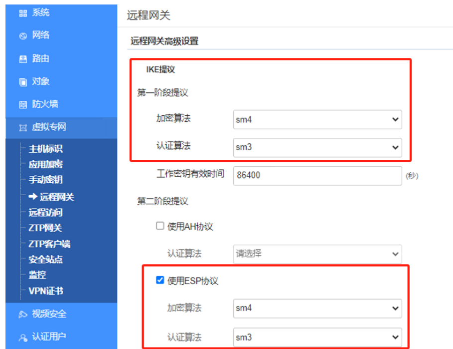
图 C.2- 10 IPsec VPN 网关的 IKE (ISAKMP) 配置界面
