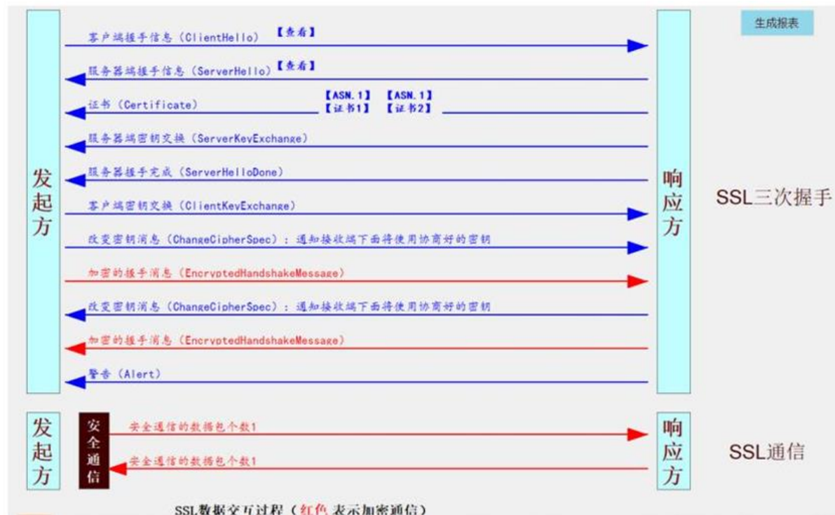
图 C.2- 15 SSL 协议握手过程解析结果 (客户端对服务端单向鉴别, 服务端具有双证书)
